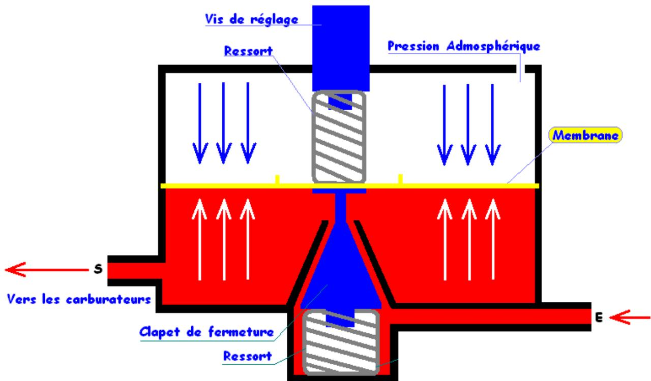
Le régulateur est constitué de deux demi-coquilles séparées par une membrane en caoutchouc. La demi-coquille du haut est à l'air libre par l'intermédiaire d'un petit trou situé sur le dessus. La demi-coquille du bas reçoit l'essence issue de la pompe en fonction du clapet de fermeture. L'entrée E reçoit le tuyau de la pompe à essence.
